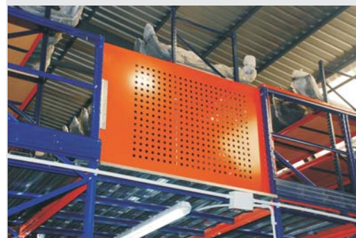
Puerta: Permite el acceso a las carretillas elevadoras, para cargar y descargar mercancías.
